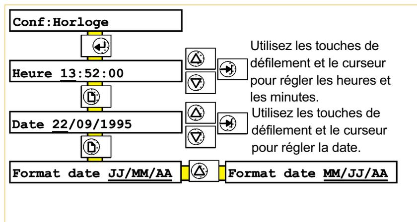
Figure 4.8 Pages de configuration de l'horloge
