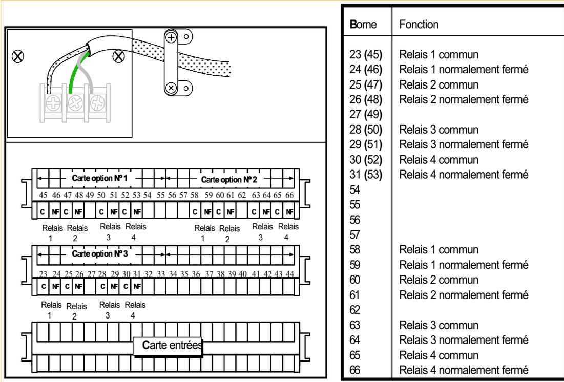
Figure B1.2.3 Câblage carte 4 relais normalement fermés
