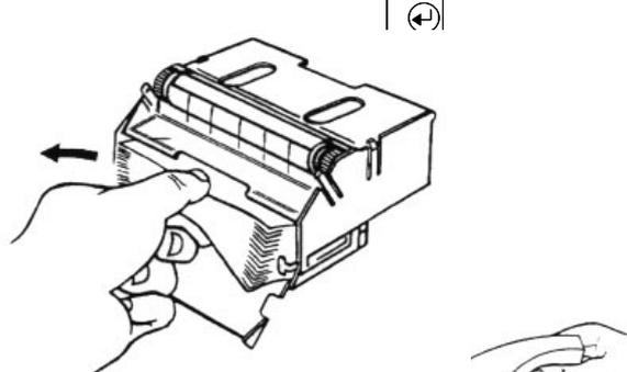
Une fois le diagramme déramé, il doit être positionné de façon à ce que les perforations circulaires soient à gauche, les trous oblongs à droite et la bande rouge de fin de diagramme au fond du chargeur (lorsque l'on regarde la cassette depuis l'avant).
