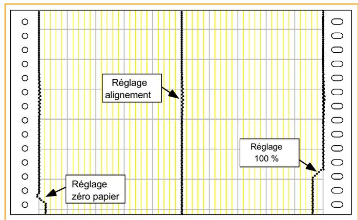
Figure 4.15.2b Diagramme de réglage diagramme complet (alignement, 0 et 100 %)
