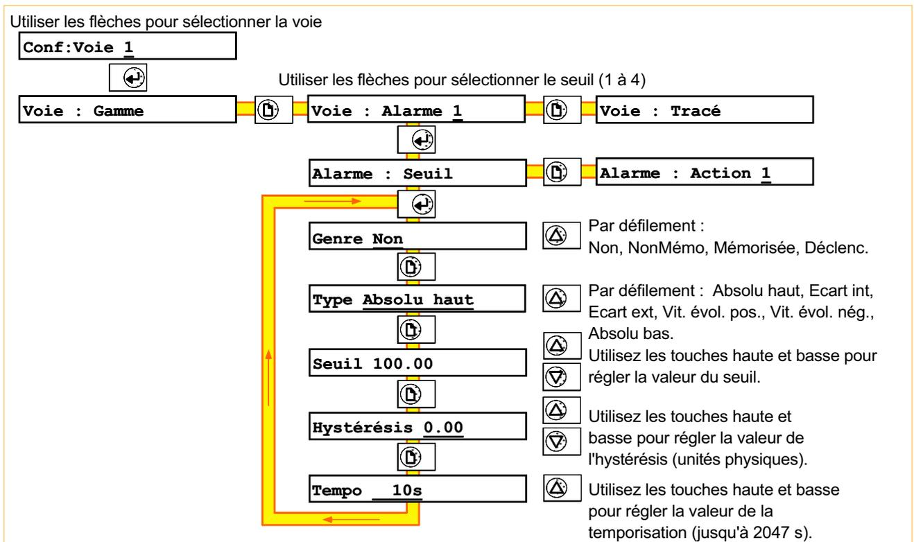
Figure 4.5.2a Pages de configuration d'une alarme absolue.
