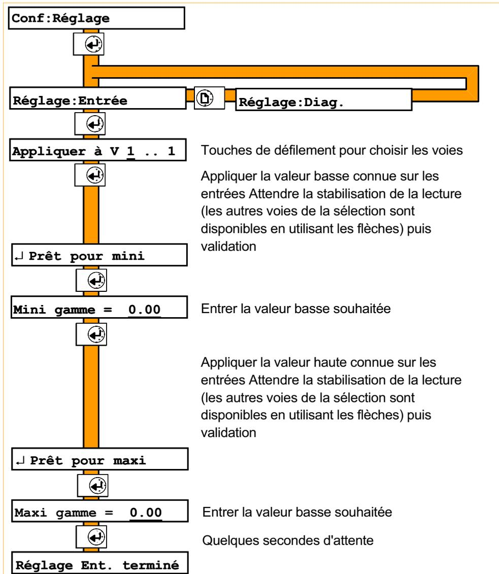
Figure 4.14.1a Pages de configuration des réglages d'entrée
