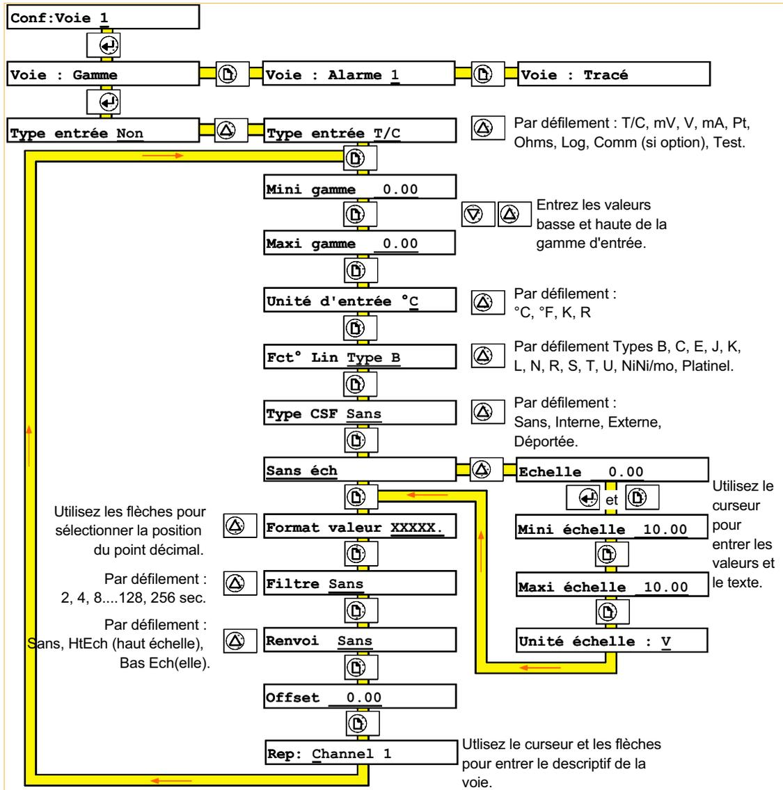
Figure 4.5.1b Pages de configuration pour un thermocouple
