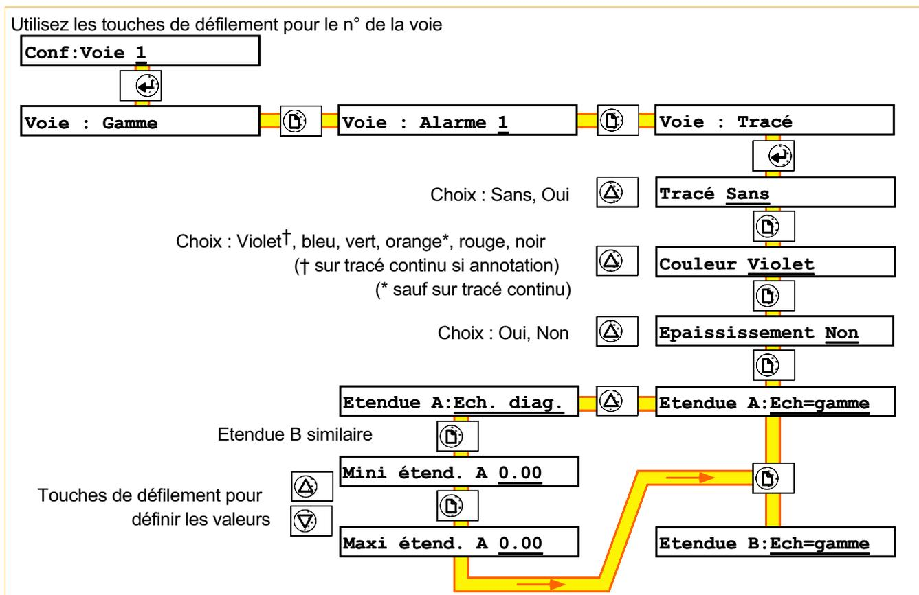
Figure 4.5.3 Pages de configuration du tracé.
