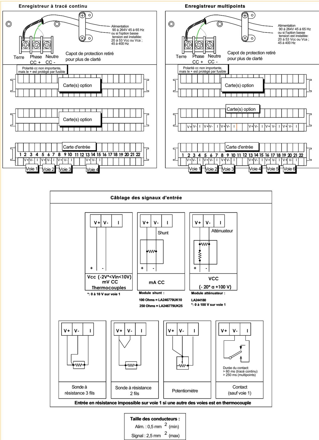
Figure 1.2.2 Installation électrique
