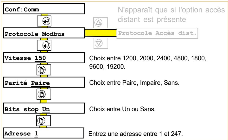
Figure B7.3 Pages de configuration de la communication
