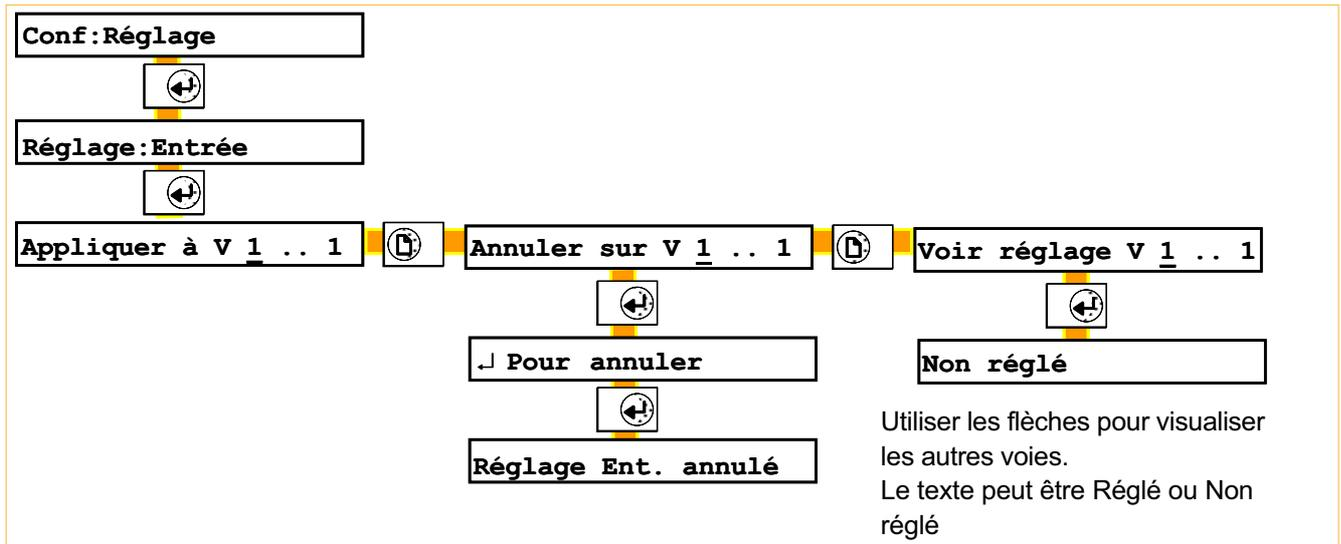
Figure 4.14.1b Pages de visualisation/annulation des réglages d'entrée
