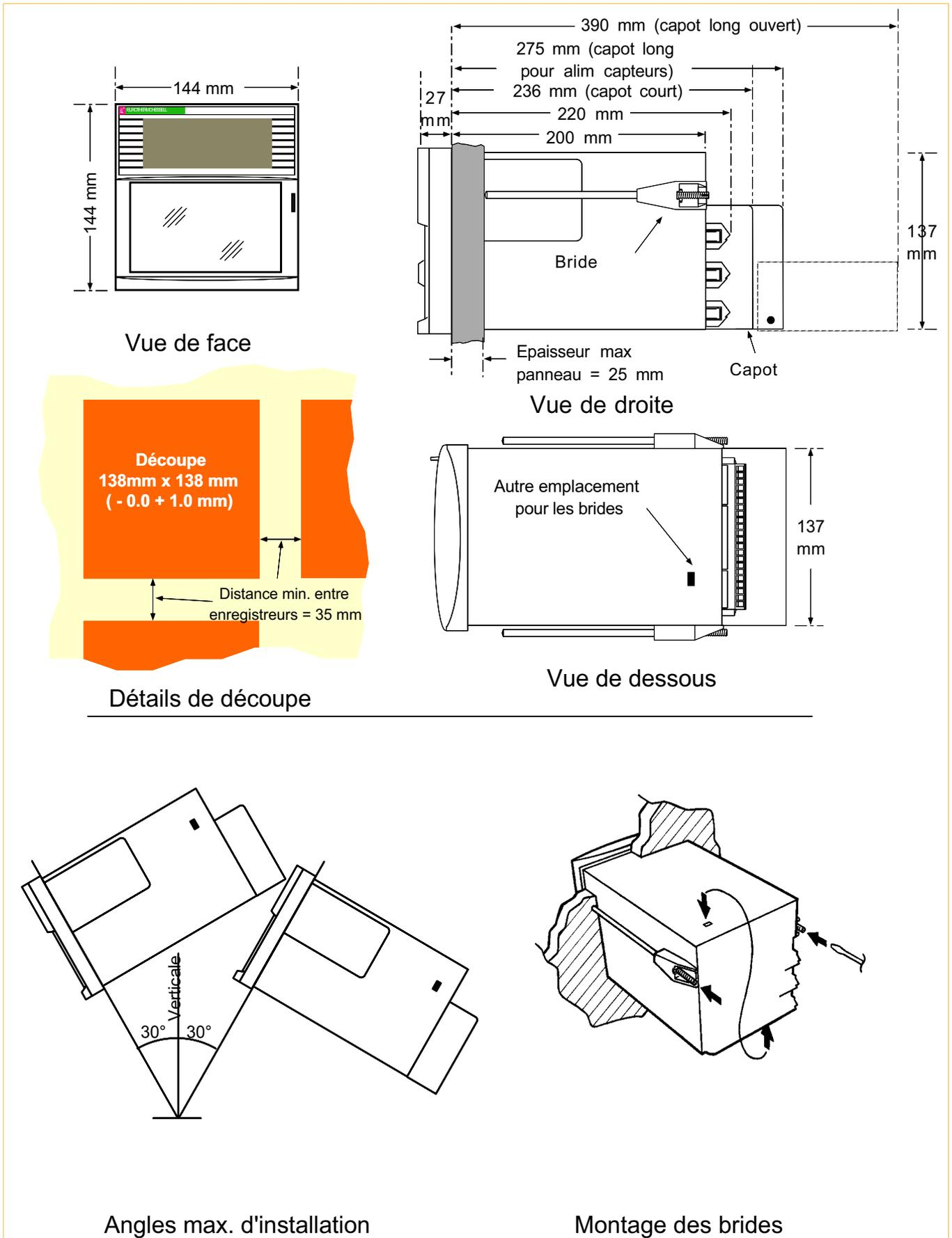
Figure 1.2.1 Installation mécanique
