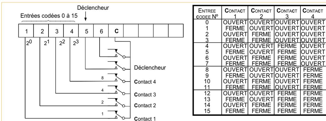
Figure B5.4 Câblage des entrées codées
